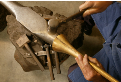
Ganz oben: eine Schallstückmacherei . Hier entstehen in diversen Einzelschritten zum Beispiel Tubas. Die einzelnen Schallstücke werden dabei gehämmert (links oben) und abgerieben (rechts oben)
