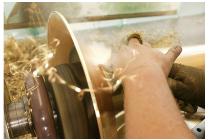
Ganz oben: eine Schallstückmacherei . Hier entstehen in diversen Einzelschritten zum Beispiel Tubas. Die einzelnen Schallstücke werden dabei gehämmert (links oben) und abgerieben (rechts oben)
